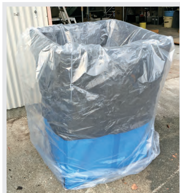
図6 作業性の向上や作業人員の削減に役立つ自立型のフレコンスタンド
